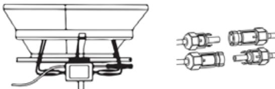
**HINWEIS:** Wenn beim Einstecken der DC-Kabel bereits Wechselstrom vorhanden ist, sollte der Mikrowechselrichter sofort rot blinken und innerhalb der eingestellten Zeit (Standard 60 Sekunden) mit der Arbeit beginnen. Wenn kein Wechselstrom vorhanden ist, blinkt das rote Licht dreimal schnell und wiederholt sich nach einer Sekunde, bis der Wechselstrom angeschlossen ist.
